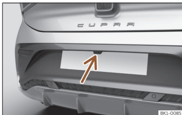
Afb. 107 In de achterbumper: inbouwplaats van achteruitkijkcamera.
