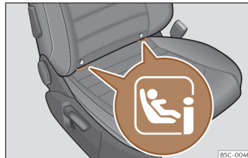
Afb. 37 Bijrijdersstoel: locatie van de i-Size-bevestigingsbeugels.
