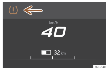
Afb. 187 Instrumentenpaneel: waarschuwing bandenspanningverlies.
