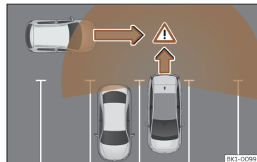
Afb. 138 Schematische voorstelling van de uitparkeerhulp: bewaakt gebied rond de wagen die een parkeerplaats verlaat
