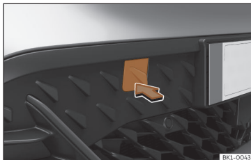
Afb. 167 Aan de rechterzijde van de voorbumper: de afdekking verwijderen.
