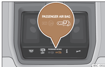
Afb. 27 In de dakconsole: controlelampje van uitschakeling bijrijdersairbag.
