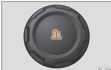
Afb. 176 Voorruimte: vuldop van het koelvloeistofexpansiereservoir.
