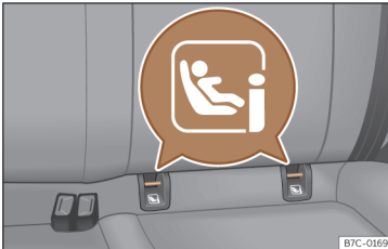
Afb. 36 Achterstoel: locatie van de ISOFIX- of i-Size-bevestigingsbeugels.
