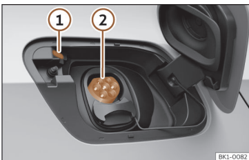
Afb. 52 Achter de laadklep van de accu, rechtsachter: Laadcontactdoos.
