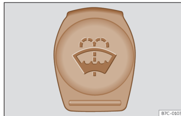
Afb. 178 In de voorruimte: blauwe dop van het ruitensproeier-vloeistofreservoir.
