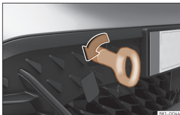
Afb. 168 Voorbumper rechts: ingeschroefd sleepoog.
