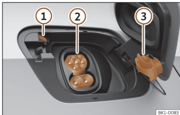
Afb. 53 Achter de laadklep van de accu, rechtsachter: laadcontactdoos.
