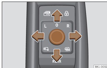
Afb. 94 Detail van het bestuurdersportier: bedieningselement voor buitenspiegel.
