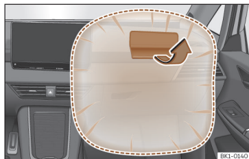
Afb. 25 Bijrijdersairbag in het dashboard.
