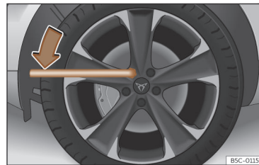
Afb. 184 Wiel verwisselen: wielbouten losdraaien.
