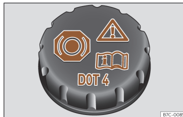
Afb. 177 Voorruimte: dop van het remvloeistofreservoir.
